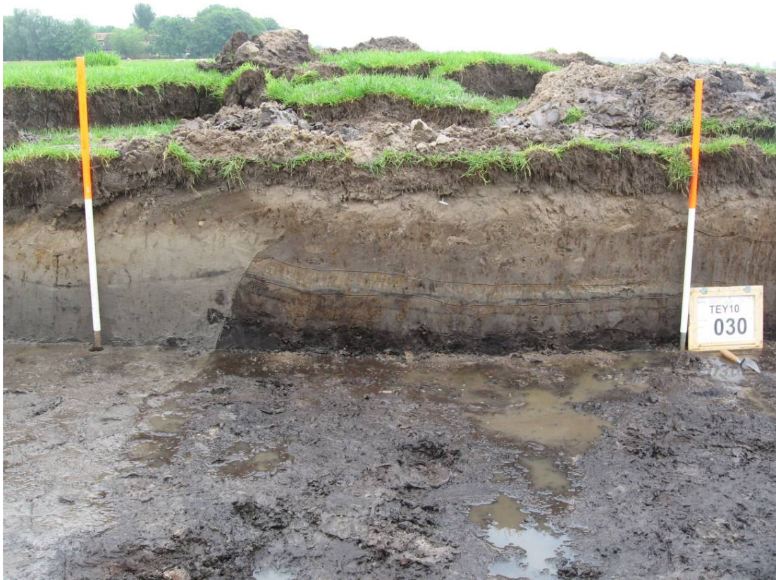
Bijlage 3.9 Grens tussen het aangebrachte zandpakket (S78 met veenbrokken en mogelijk een vegetatiehorizont of vuil laagje) en de natuurlijke strandvlakteafzettingen (zand op zandige klei op veen) Foto in zuidwestelijke richting. Foto: Grontmij
